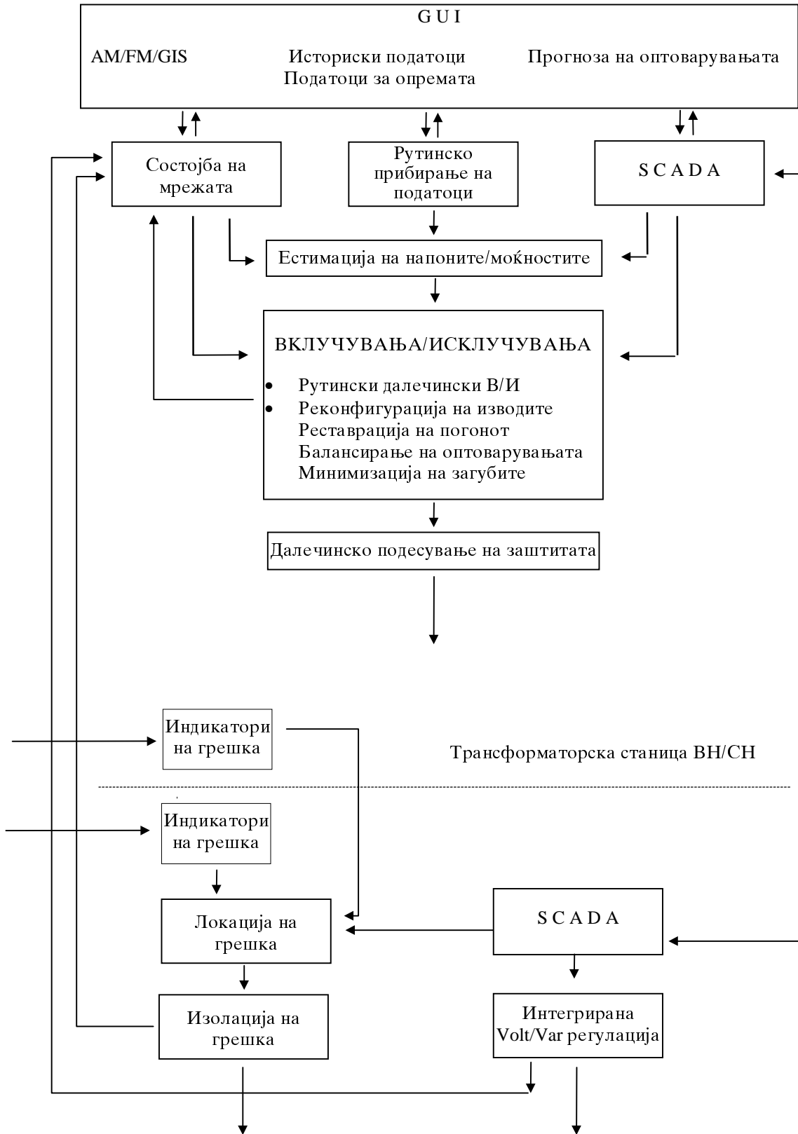
Слика 1. Структурна шема на проширениот прототип систем за автоматска контрола и управување со дистрибутивните системи
